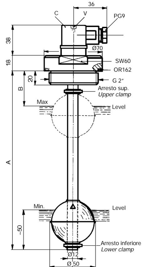
Le sonde di livello SL1FIA... SL2FIA... e SL1TIA... SL2TIA... sono state concepite per controllare a distanza in continuo il livello di un liquido contenuto in un serbatoio di stoccaggio, mediante i nostri strumenti di lettura elettronici.
