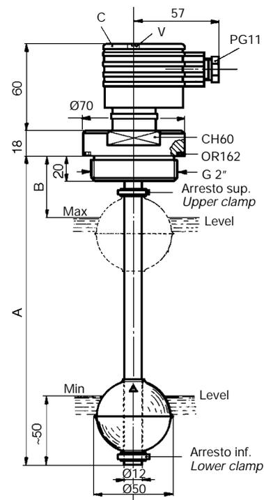
Le sonde di livello SL1F3IA... SL2F3IA... e SL1T3IA... SL2T3IA... sono state concepite per controllare il livello di un liquido contenuto in un serbatoio e inviare a distanza tre segnali di allarme regolabili a piacere. Installate sopra un serbatoio contenente il fluido da controllare, trasmettono per mezzo del trasduttore lineare posto all'interno del tubo lungo il quale scorre il galleggiante con magnete, un segnale variabile, in funzione della posizione assunta dal livello del liquido.
