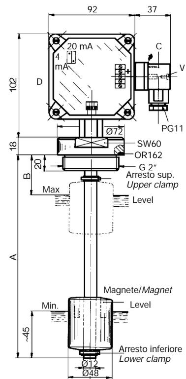
Le sonde di livello SL1FA...CVS2 SL2FA...CVS2 e SL1TA...CVS2 SL2TA...CVS2 con convertitore di segnale 4/20 mA alloggiato nella custodia D, sono state concepite per controllare in continuo il livello di un liquido contenuto in un serbatoio di stoccaggio.
