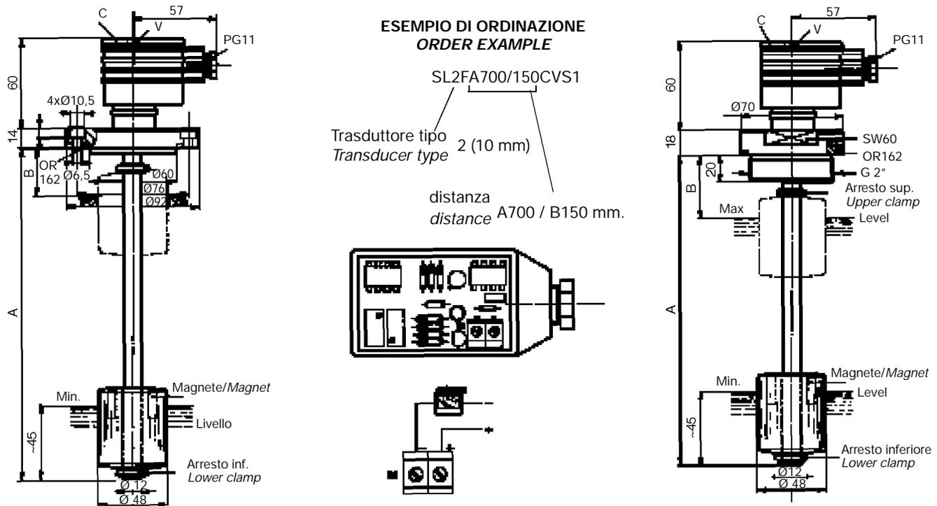
Le sonde di livello SL1FA...CVS1 SL2FA...CVS1 e SL1TA...CVS1 SL2TA...CVS1 con convertitore di segnale 4/20 mA alloggiato nel connettore C, sono state concepite per controllare in continuo il livello di un liquido contenuto in un serbatoio di stoccaggio.
