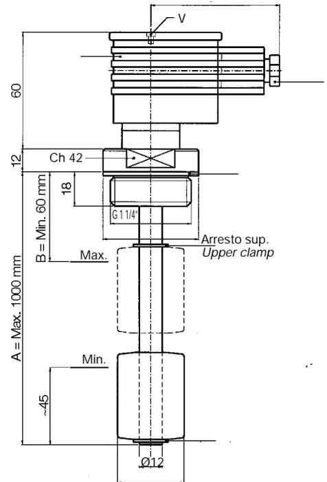
Le sonde di livello SL1M3FA... SL2M3FA... e SL1M3TA... SL2M3TA... sono state concepite per controllare il livello di un liquido contenuto in un serbatoio e inviare a distanza tre segnali di allarme regolabili a piacere.
