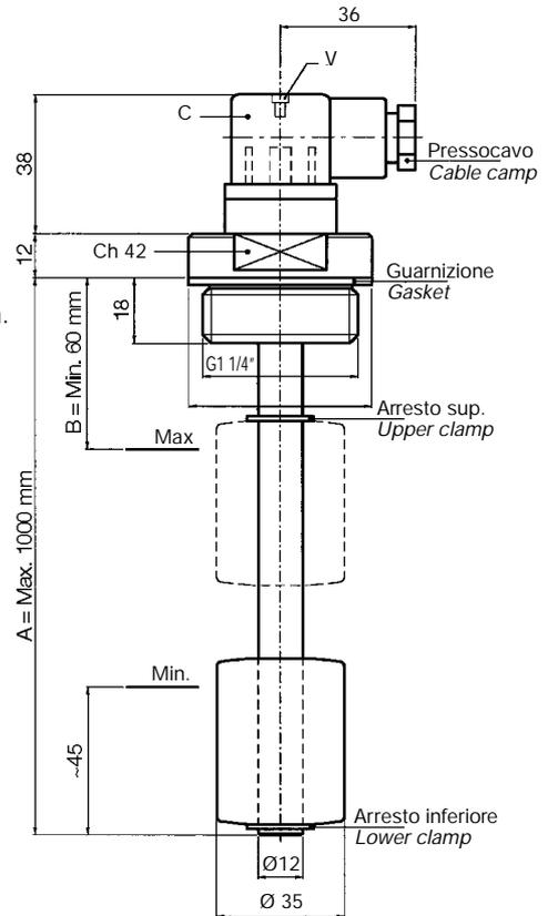
Le sonde di livello SLM1FA... SLM2FA... e SLM1TA... SLM2TA... sono state concepite per controllare a distanza in continuo il livello di un liquido contenuto in un serbatoio di stoccaggio, mediante i nostri strumenti di lettura elettronici.
