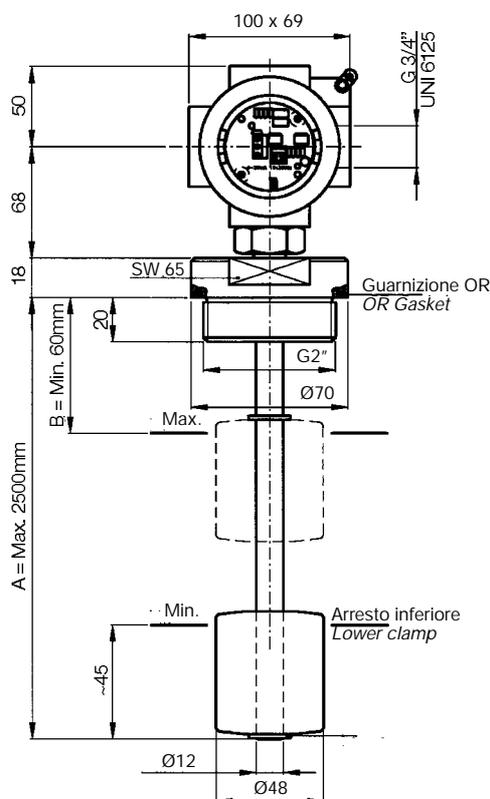
Le sonde di livello SL1TA...B... e SL2TA...B...CVS3EP con convertitore di segnale 4/20 mA sono state concepite per controllare in continuo il livello di un liquido contenuto in un serbatoio di stoccaggio.
