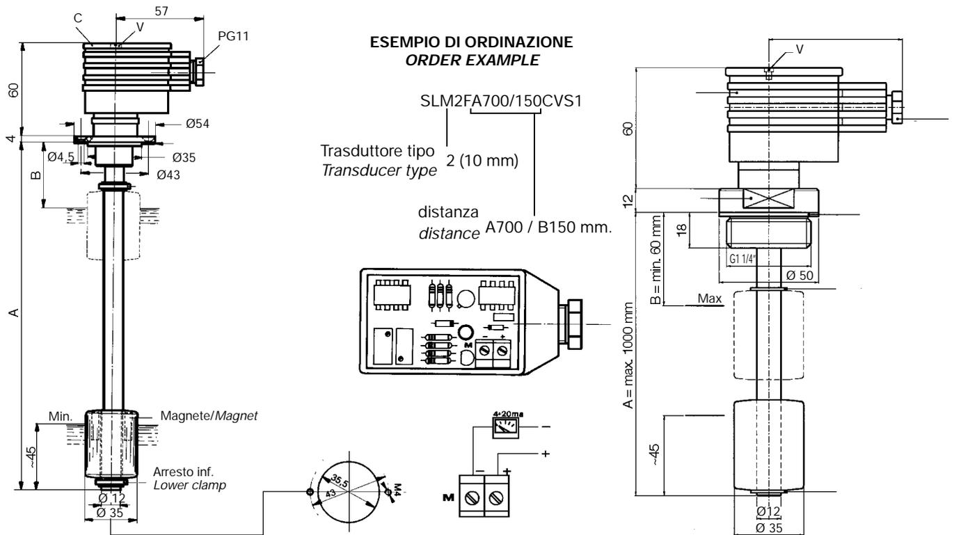
Le sonde di livello SLM1FA...CVS1 SLM2FA...CVS1 e SLM1TA...CVS1 SLM2TA...CVS1 con convertitore di segnale 4/20 mA alloggiato nel connettore C, sono state concepite per controllare in continuo il livello di un liquido contenuto in un serbatoio di stoccaggio.
