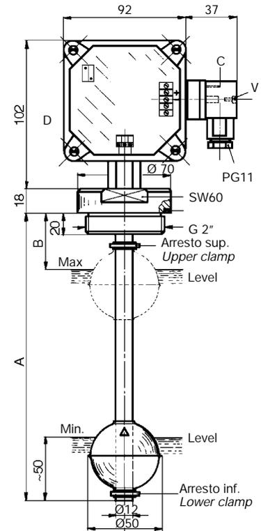
Le sonde di livello SL1FIA...CVS2 SL2FIA...CVS2 e SL1TIA...CVS2 SL2TIA...CVS2 con convertitore di segnale 4/ 20 mA alloggiato nella custodia D, sono state concepite per controllare in continuo il livello di un liquido contenuto in un serbatoio di stoccaggio.
