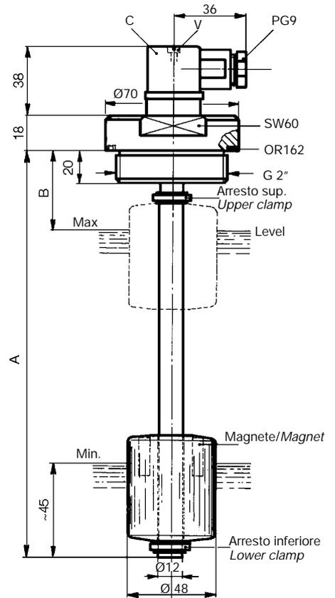
Le sonde di livello SL1FA... SL2FA... e SL1TA... SL2TA... sono state concepite per controllare a distanza in continuo il livello di un liquido contenuto in un serbatoio di stoccaggio, mediante i nostri strumenti di lettura elettronici.
