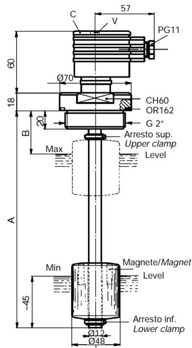
Le sonde di livello SL1F3A... SL2F3A... e SL1T3A... SL2T3A... sono state concepite per controllare il livello di un liquido contenuto in un serbatoio e inviare a distanza tre segnali di allarme regolabili a piacere. Installate sopra un serbatoio contenente il fluido da controllare, trasmettono per mezzo del trasduttore lineare posto all'interno del tubo lungo il quale scorre il galleggiante con magnete, un segnale variabile, in funzione della posizione assunta dal livello del liquido.
